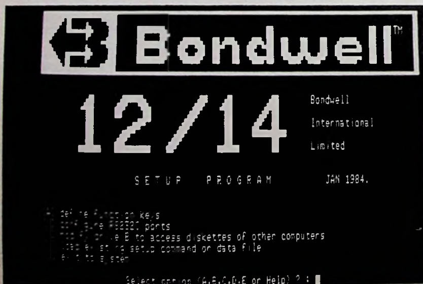
Afb. 7 Het „SETUP” programma, waarmee de Bondwell-12 hardware kan worden ingesteld.
