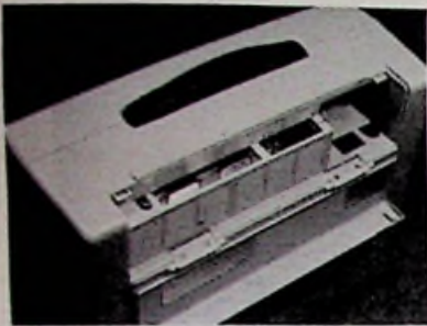
Afb. 1 Ineengeklapte Bondwell-12 van boven gezien. De klep voor de connectoren is geopend.
